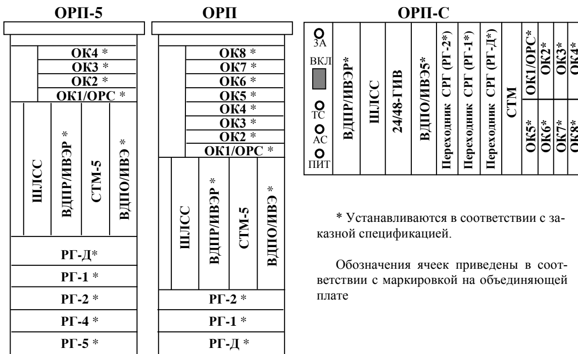
Рисунок 3.1 – Расположение ячеек в каркасах ОРП-5, ОРП, ОРП-С
